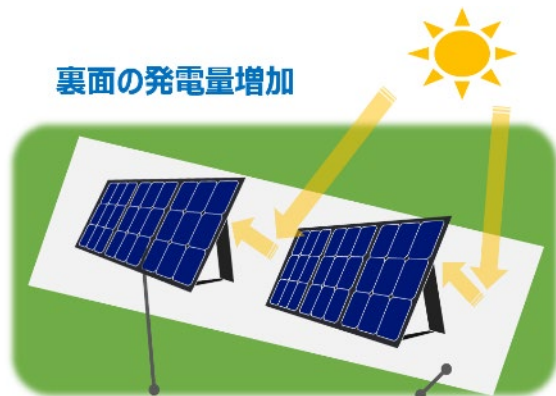
両面採光型太陽電池モジュール DNP太陽光発電所用反射シート
