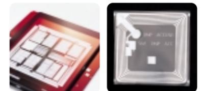
フォトマスク IC、LSIなどの製造工程で、シリコンウェハー上に微細な回路パターンを形成するときに使用する原版です。
