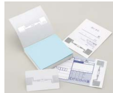
紙製UHF帯ICタグを使ったサンプル
